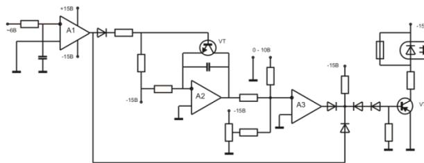
Схема управления силовым тиристором
